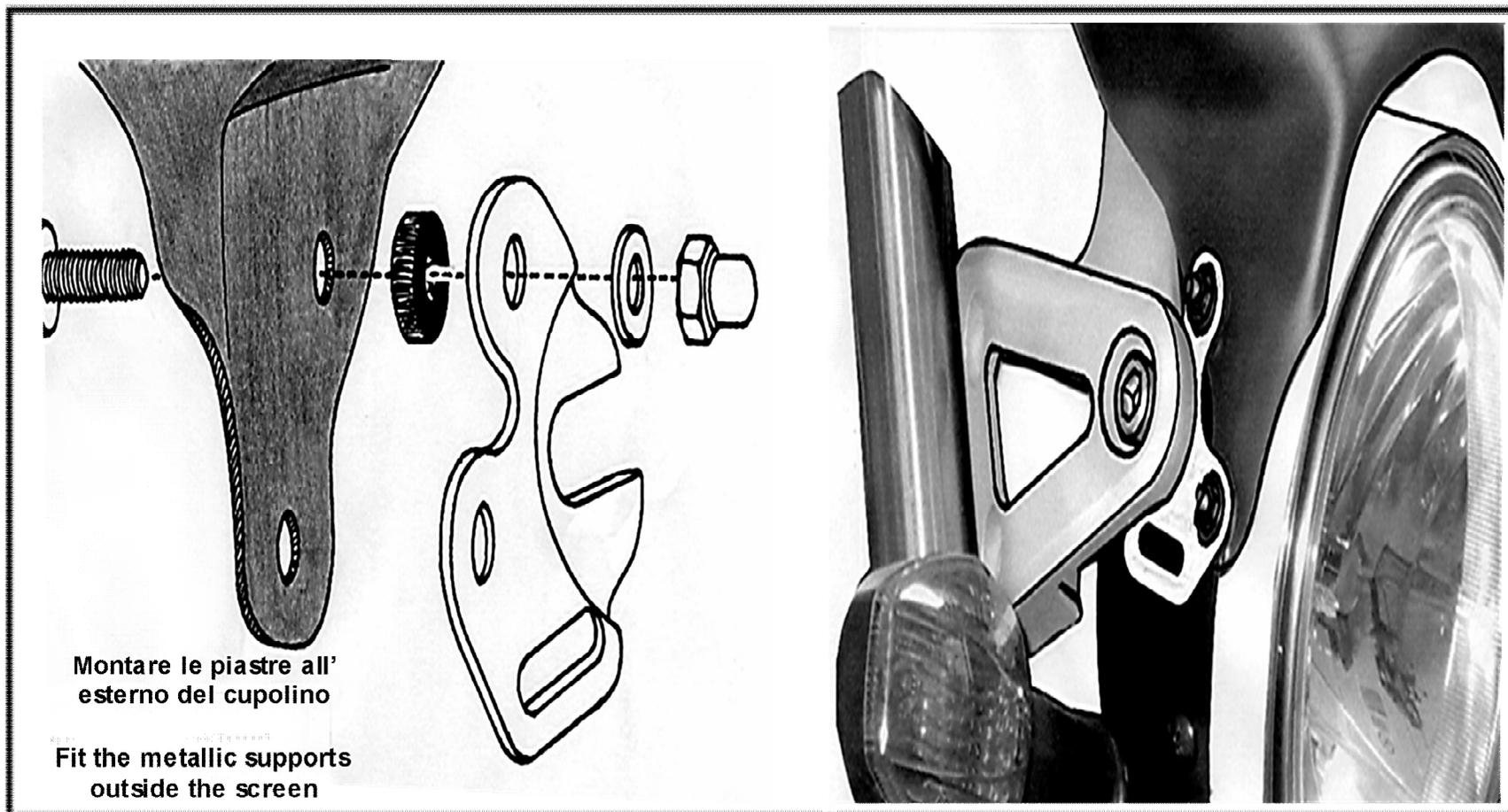
**Allentare le viti del fanale, inserire il cupolino con i supporti pre montati, quindi fissare avvitando le viti del fanale.**
